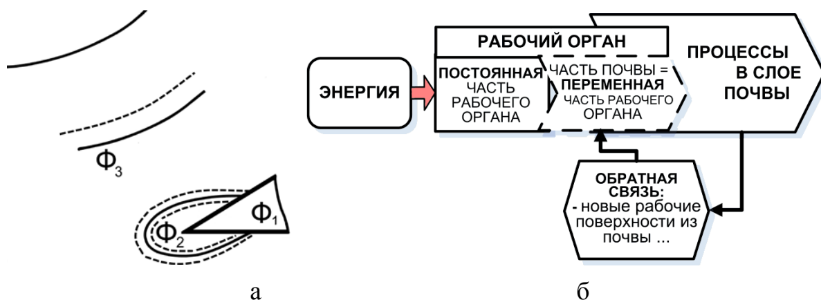
Рисунок. Схема деления пласта почвы на различные зоны (а) и структурная схема, возникающей при этом системы (б)
